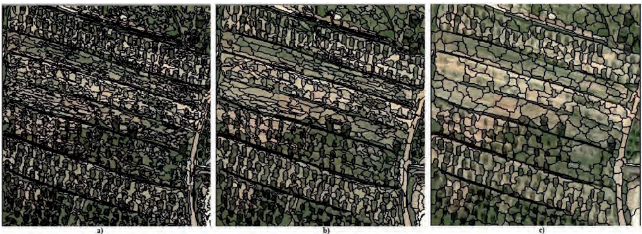
Fig. 5: Resultado de la segmentación al variar los parámetros color y forma: a) color=0.9 y forma=0.1; b) color=0.5 y forma=0.5 y c) color=0.1 y forma=0.9
