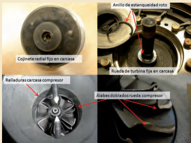
Figura 10. Fotografías de las piezas del segundo turbocompresor BWGTA17-SFRB, ensayo interrupción de lubricación
