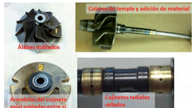
Figura 5: Fotografías turbocompresor BW-BV39-FRB, ensayos a baja presión con alto ratio de aceleración
