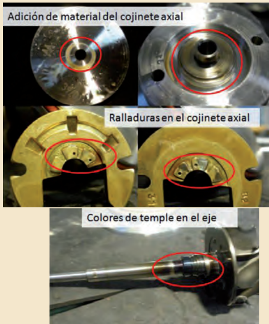
Figura 9. Fotografías de las partes del primer turbocompresor BW-KP35-FRB, ensayo interrupción de lubricación
